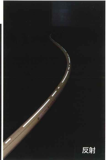
蓄光または光りを当てるとシルバーに反射するので暗闇でも、それを辿れば退路方向が分かります。
